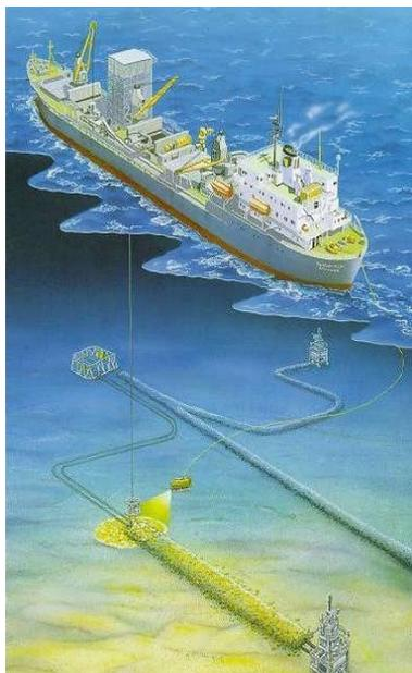
Figure 12 : Moyen maritime pour le placement des roches sur un câble
