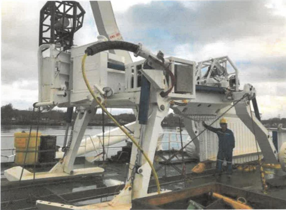
**Figure 13 : Illustration du type de charrue qui sera utilisée**
