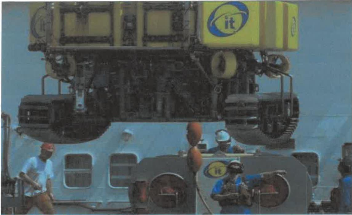
**Figure 15 : Illustration d'un ROV dédié au PLIB**
