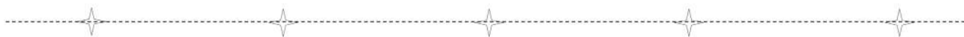
IMPLANTATION EN UNE SEULE LIGNE AVEC INTERVALLES IMPORTANTS : Lecture lisible potentielle seulement à grande distance
