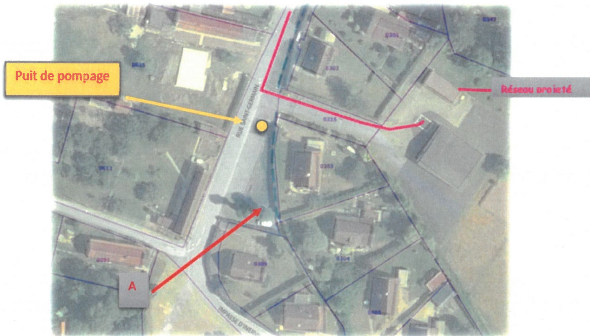
Pompage de la zone de travaux rue St Germain - Bellengreville
